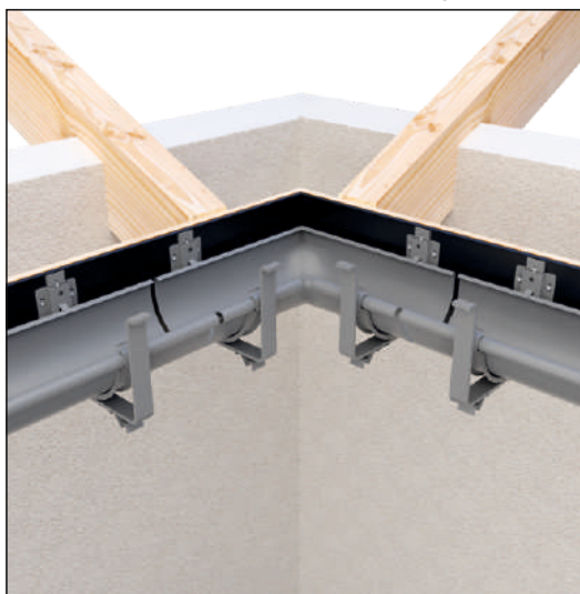
Ринви і кути монтуємо на гаки із зазором 5-10 мм (для термічного розширення).
