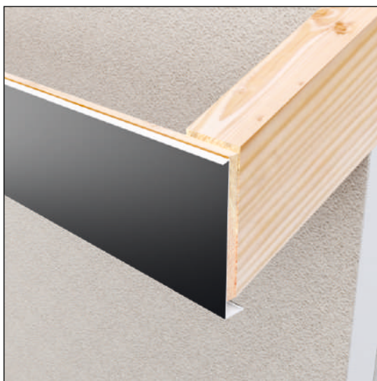
Монтаж нижнього звісу до стартової планки. Нижній згин дає можливість змонтувати підшиву (софіти) до цієї планки (див. стор. 20).
