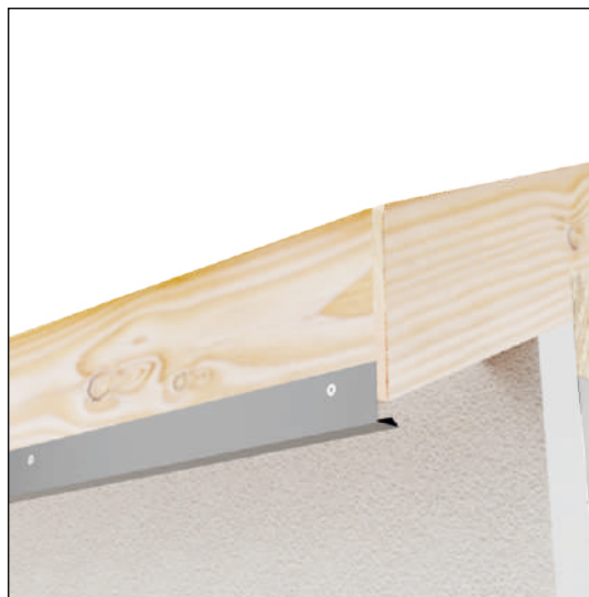
Встановлення стартової планки.
