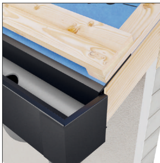
Монтування підконструкції згідно інструкції монтажу покрівлі. Рекомендовані розміри обрешітки та контррейок - 40x60 мм.
