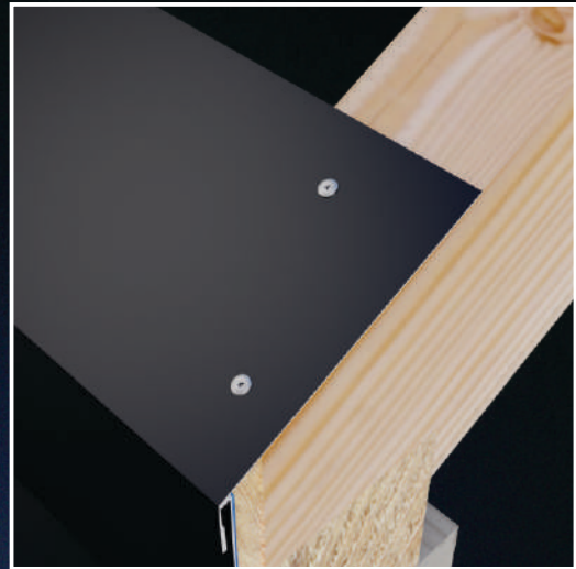
Звіс монтуємо до обрешітки за допомогою саморізів с плоскими шляпками.
