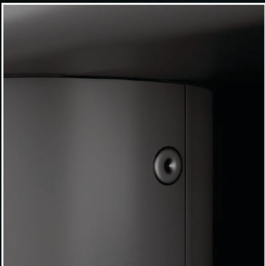
Трубу до лійки кріпимо за допомогою заклепок.
