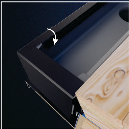
Зачеплюємо заглушку накладки на згин.
