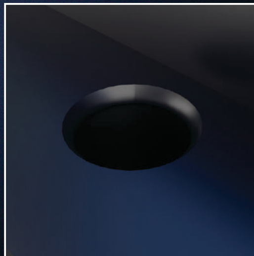
Отвір у планці повинен бути діаметром приблизно на 1 см менше від отвору в OSB-пліті, для того, щоб можна було вмонтувати ущільнювальний гумовий елемент всередину планки.
